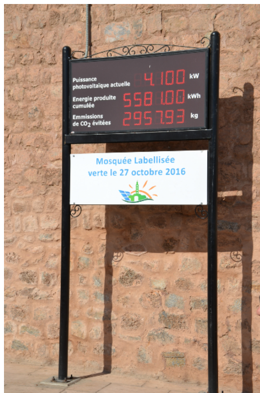
Figura 2: Medidas da geração de energia fotovoltaica em mesquita (Marrakesh, Marrocos – 2017).
